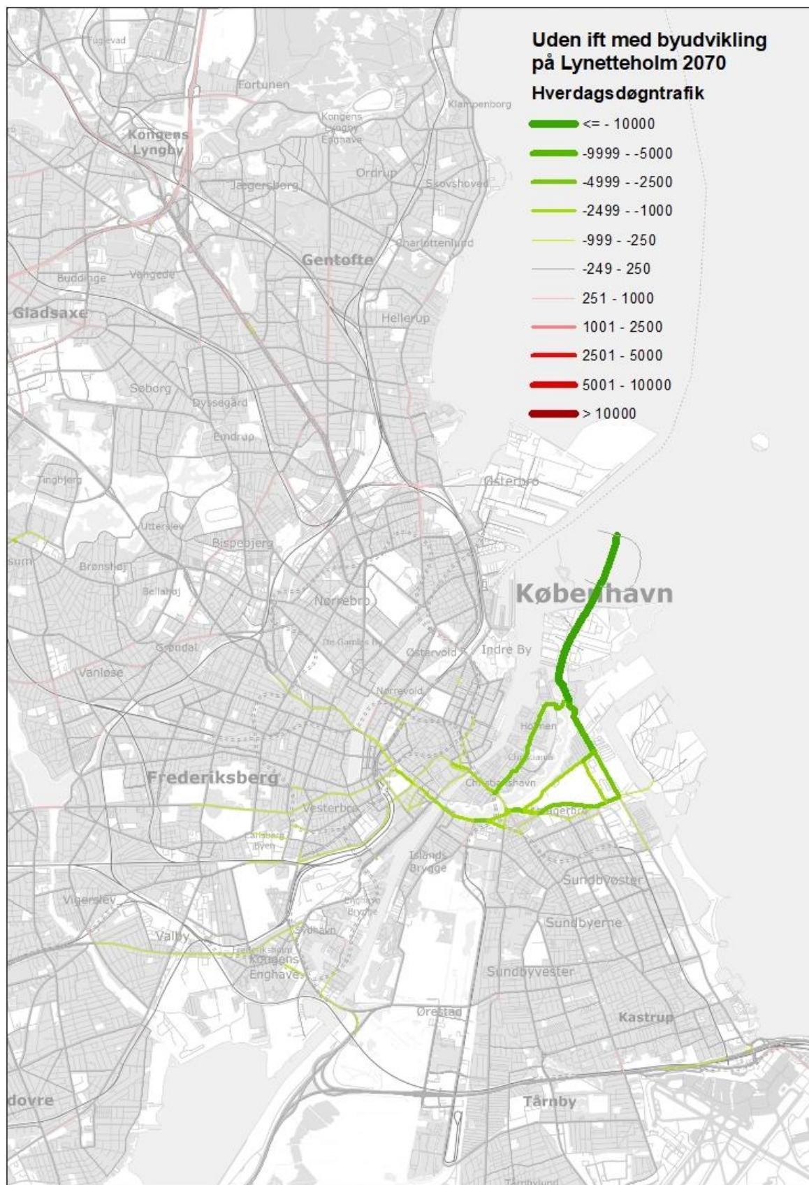
Figur 18 Forskel i hverdagsdøgnetrafik i 2070 i scenariet uden byudvikling på Lynetteholm i forhold til scenariet med byudvikling på Lynetteholm. Figur 18 viser, at der i scenariet uden byudvikling er mindre trafik på Forlandet, Refshalevej og Refshalevejs Forlængelse og Indre By. Der er mere trafik på de fleste andre veje uden for København i scenariet uden byudvikling på Lynetteholm.
